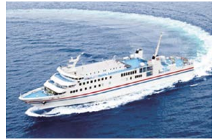
Taiko, ferry, Nomo Shosen K.K. 6DCM-32e(L) × 2, Usuki Shipbuilding Co., Ltd.
