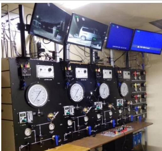
ダイバーコントロールユニット Diver control unit
