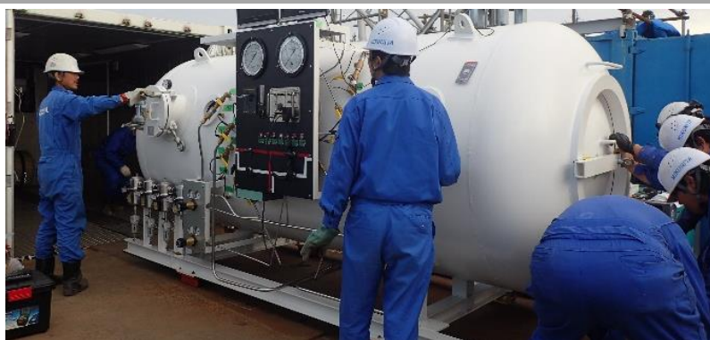
再圧室 Recompressing chamber
