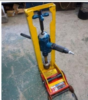
ニューマチックドリル Pneumatic drill
