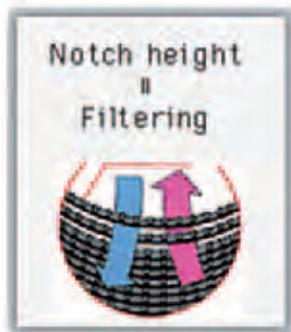
Filterungsprinzip der Notch Wire Filterelemente
