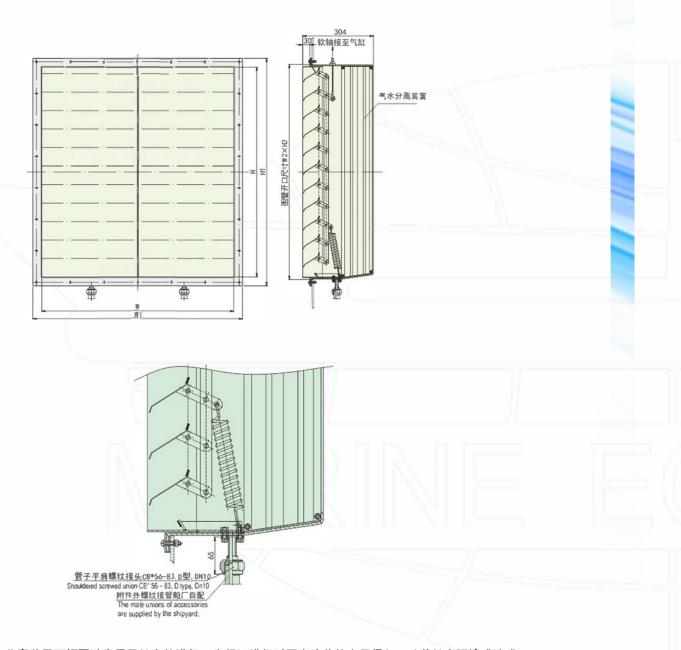
本带气水分离装置可闭百叶窗用于舱室的进气,为保证进气时雨水浪花的大量侵入,改善舱室环境或造成 机舱内柴油机吸入大量水分导致熄火而设置。
